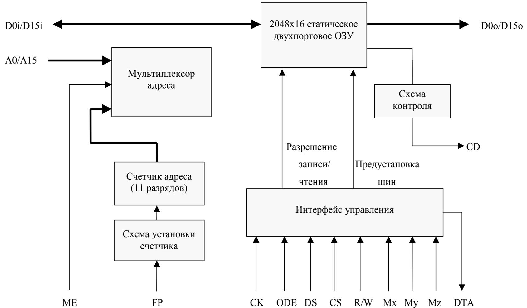
Рис. 10. Структурная схема ИС МТ9080
